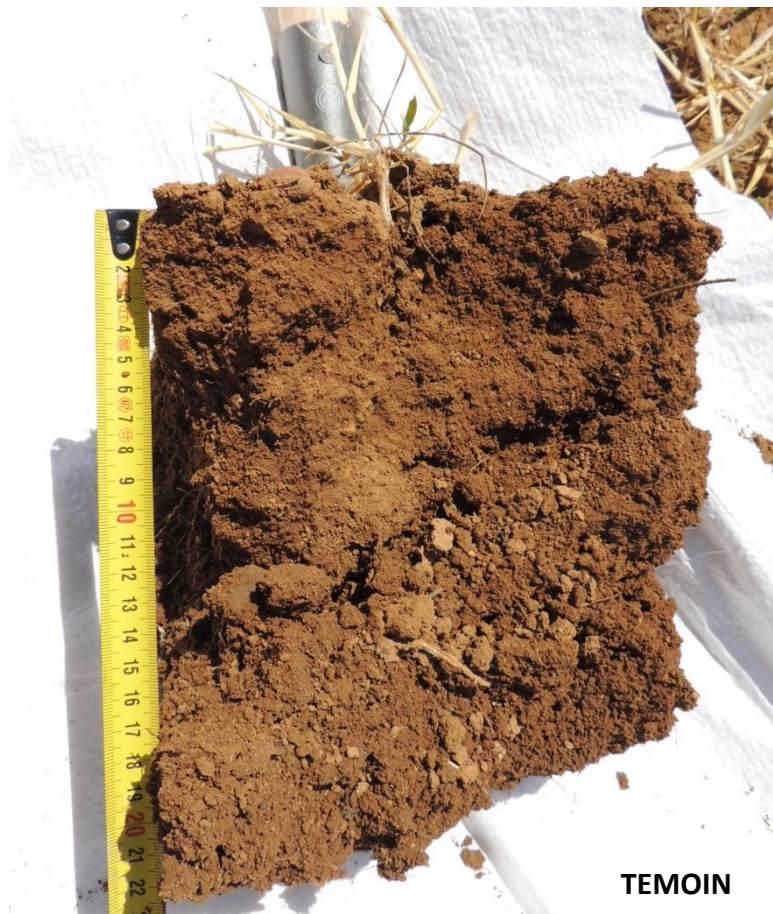
Figure 18: Photographies de bêchées de sol lors du test pelle-bêche sur le site M, dans une parcelle C30 (en haut) et une parcelle T (en bas).
