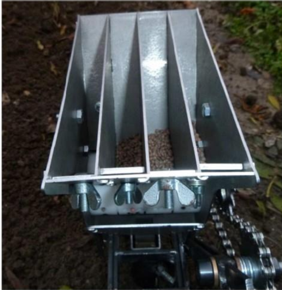
Figure 40 : Les trémies du distributeur du semoir manuel
