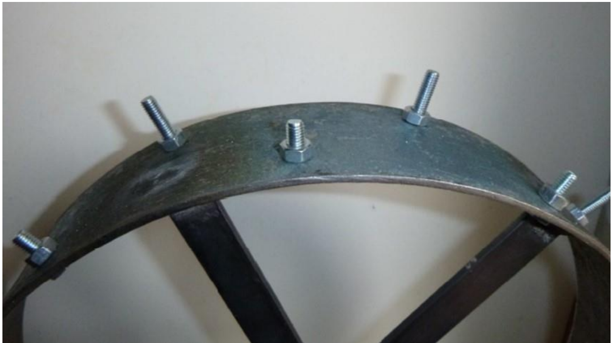
Figure 38 : L'adhérence des roues du semoir améliorée
