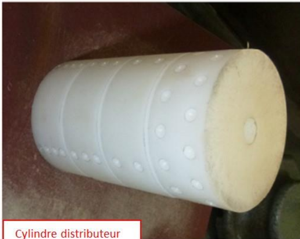
Figure 41 : Le cylindre distributeur du semoir manuel
