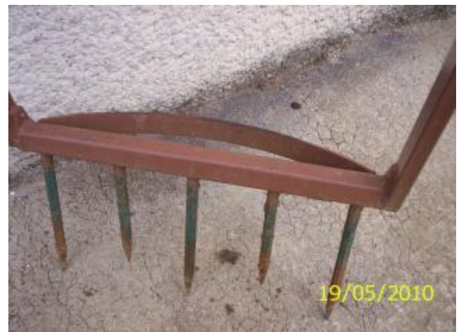
Figure 2 : Une fourche à bêcher avec arceau « bras de levier » pour réduire l'effort
