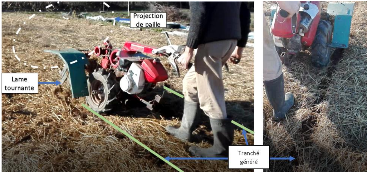
Figure 65 : L'écarteur de paille de Pierre en cours d'utilisation
