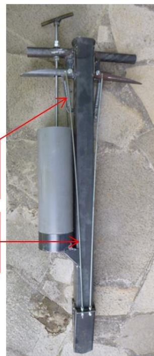
Figure 22 : Détail du système de fermeture du bec de la canne à planter modèle Guyane
