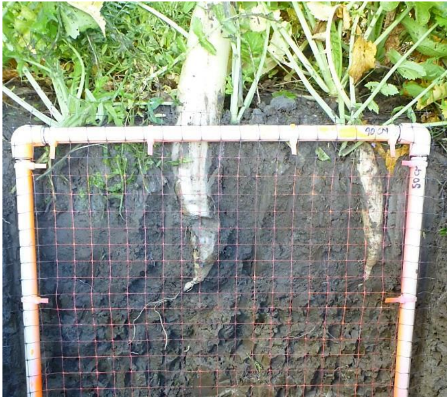
Figure 17 : Racine principale du radis qui frappe la couche compactée et sort de terre. Site Monlou - sol argileux – 2012.
